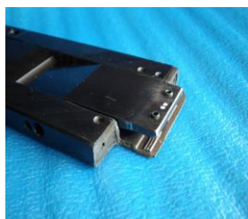
クランプベースの破損
