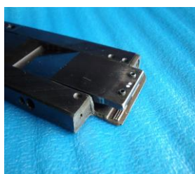
クランプベースの破損
