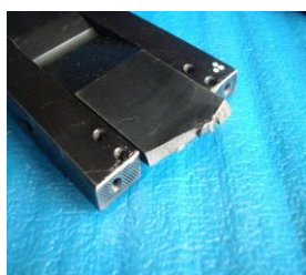
クランパーの破損
