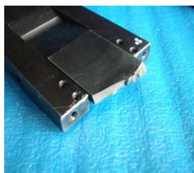
クランパーの破損
