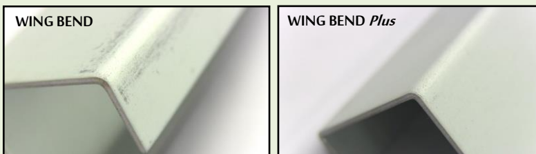
曲げ比較写真 加工材:SECC T=1.6
