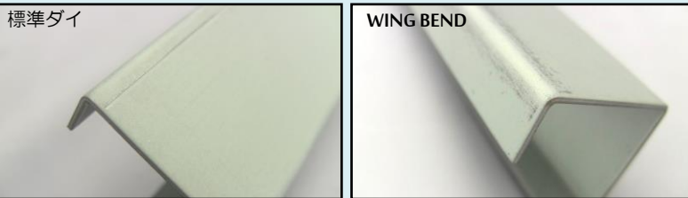
曲げ比較写真 加工材:SECC T=1.6
