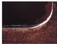
⑧追抜き偏荷重によるカジリ例 →片バリ・異常摩耗へ
