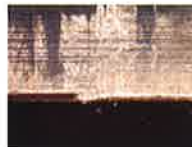
④激しい溶着・欠け・カジリ発生例 →抜き穴不良、ストリップミスへ
