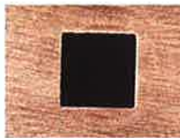
⑨再研磨量不足によるエッジ部の欠け例 →バリ・エッジ部欠損へ
