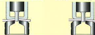
【図2】ガイド及びダイにテーパを付けた抜き加工
