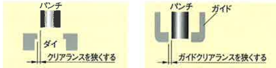
【図1】パンチとダイのクリアランス 【図2】パンチとガイドのクリアランス
