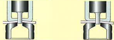
【図2】ガイド及びダイにテーパを付けた抜き加工
